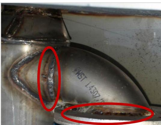
**Slika 3:** Cijev od nehrđajućeg čelika 1.4307 unutar spremnika otpadnih voda od nehrđajućeg čelika
